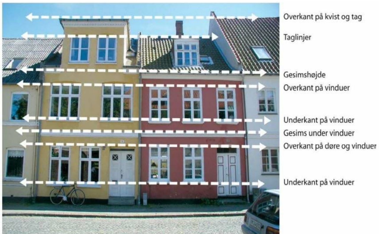
Figur: Billedet illustrerer, hvordan der mellem den gule og røde bygning er skabt sammenhæng på tværs af skel ved at viderefører linjer såsom over- og underkanten af vinduer, gesims, overkant dør, tagkant mv. På den måde skabes harmoni, samtidig med, at hver bygning er sin egen.
